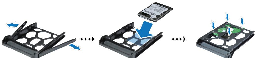
**4** Поверните диск стороной с отметкой "UP" вверху и вставьте его в отсек для дисков. Если лоток вставлен правильно, раздается щелчок.
