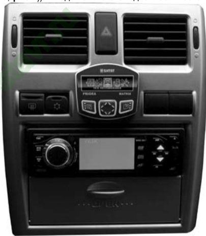
Рис. 12 Вид установленного БК
